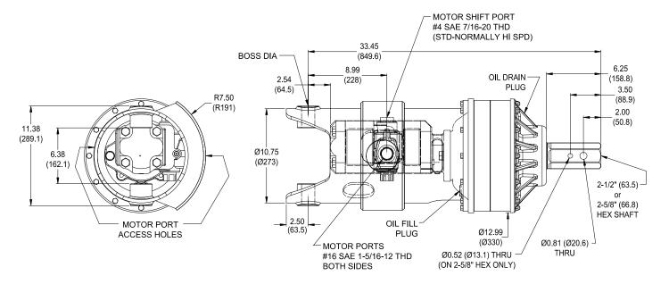
TWO-SPEED, SHIFT-ON-THE-FLY HEAVY DUTY, HIGH EFFICIENCY, DOUBLE PLANETARY DRIVE
